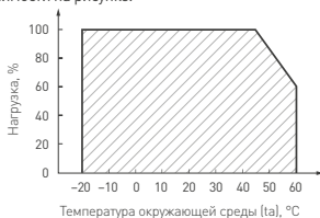
Рис. 1. Максимальная допустимая нагрузка, % от мощности источника
